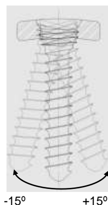
Figura: Ilustração da variação do ângulo no orifício da placa.
